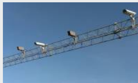
Kamery ANPR zamontowane na bramownicy
